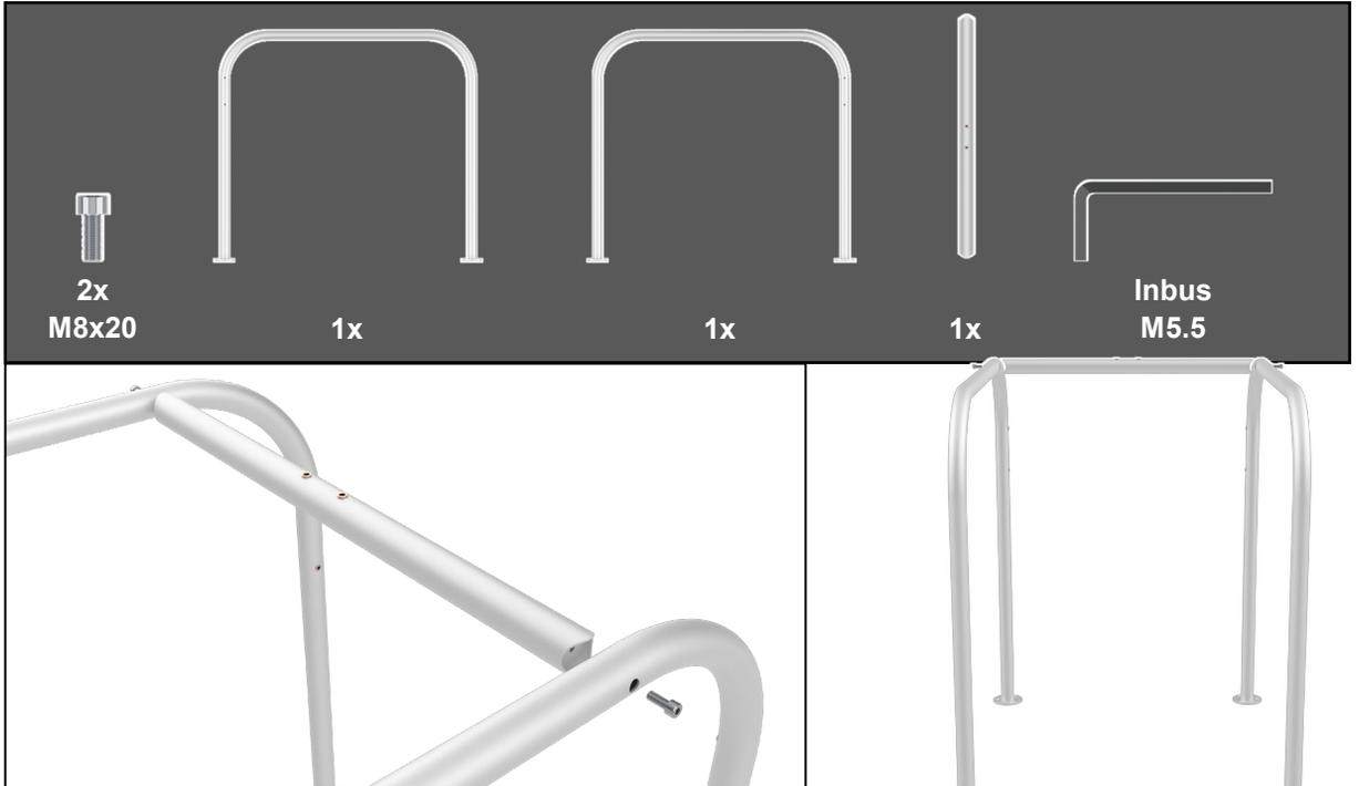
Achten Sie darauf die Schrauben nicht fest zu ziehen, um im folgenden Schritt die Box einfacher einsetzen zu können.
